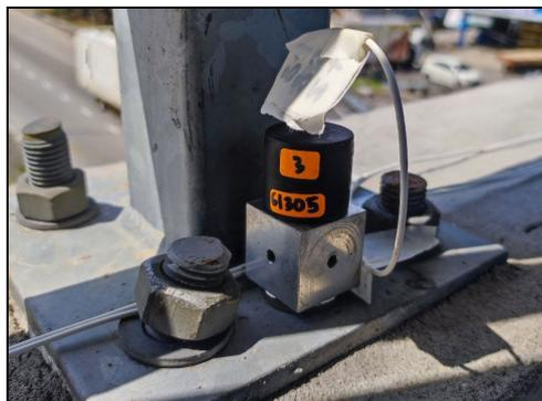
**Fig. 3** Accelerometer sensor
