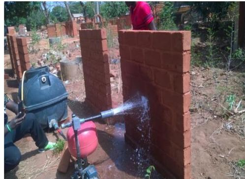
Fig. 6 – Spray test
