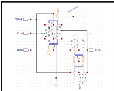
*Figure 3 Module II Sum Circuit*
