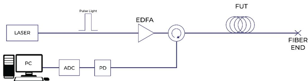
**Fig. 2** OTDR setup
