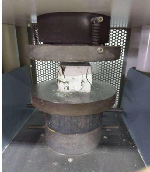
**Fig. 6 - Compression test**
