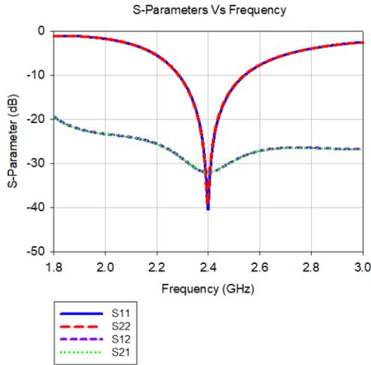
**Fig. 3 - The values S-Parameters MIMO Antenna**
