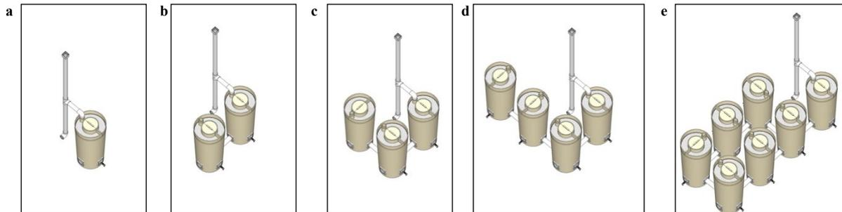
**Fig. 5 - a) Single tank; b) twin tank; c) triplet tank; d) quadruplet tank; e) septuplet tank**
