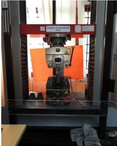
Fig. 3 - Tensile machine - ZWICK Roell Z0100
