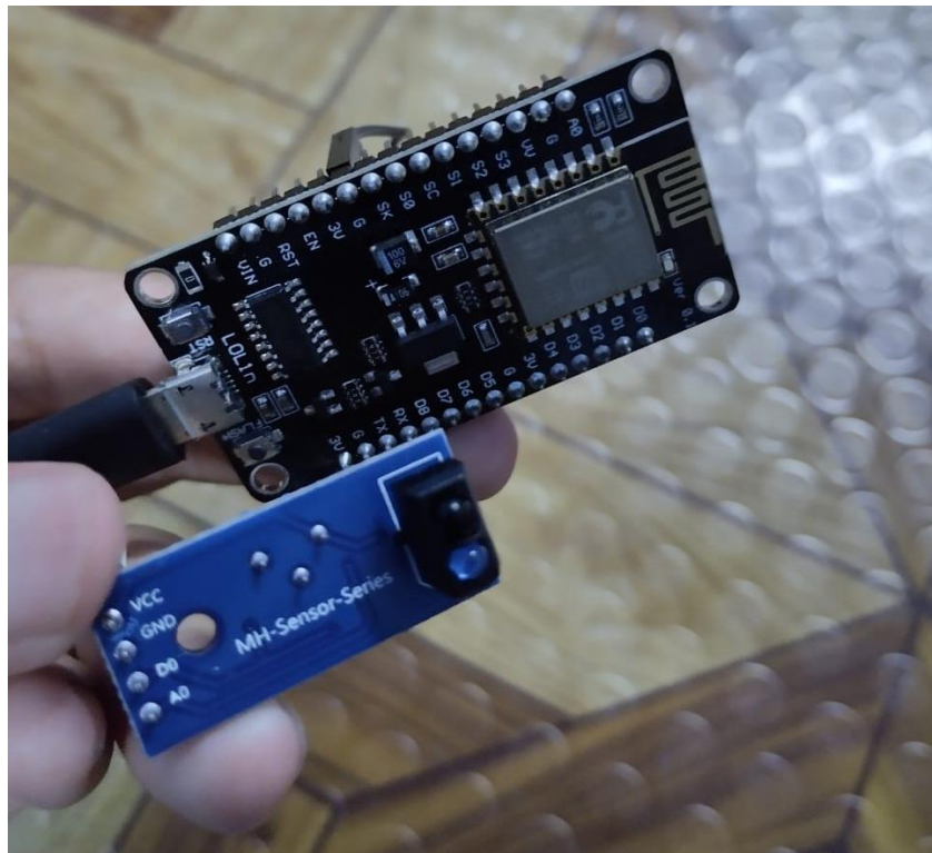
Rajah 18: Sensor Cahaya bersambung dengan ESP8266
