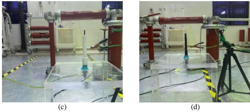
Fig. 3 Type of insulator (a) uninsulated rod (b) acrylics (c) teflon (d) Polyolefin
