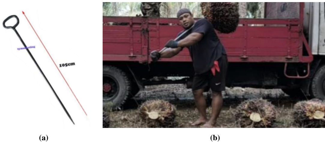
Rajah 1 (a)Besi pencucuk BTS ( chop ) [5]; (b) Proses pemunggahan BTS menggunakan chop [6]
