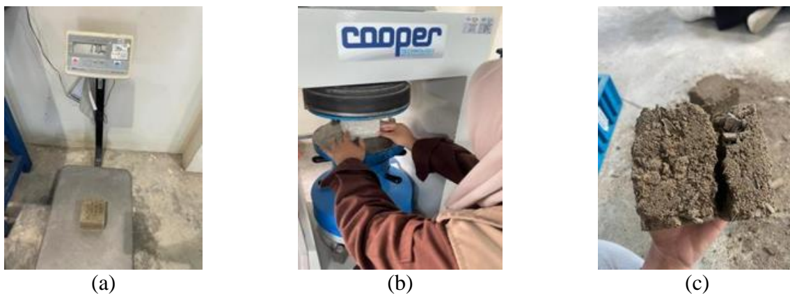
Rajah 3 Ujian makmal terhadap bata (a) Proses penimbangan sampel; (b) Proses pengujian kekuatan mampatan; (c) Bata yang mengalami kegagalan struktur
