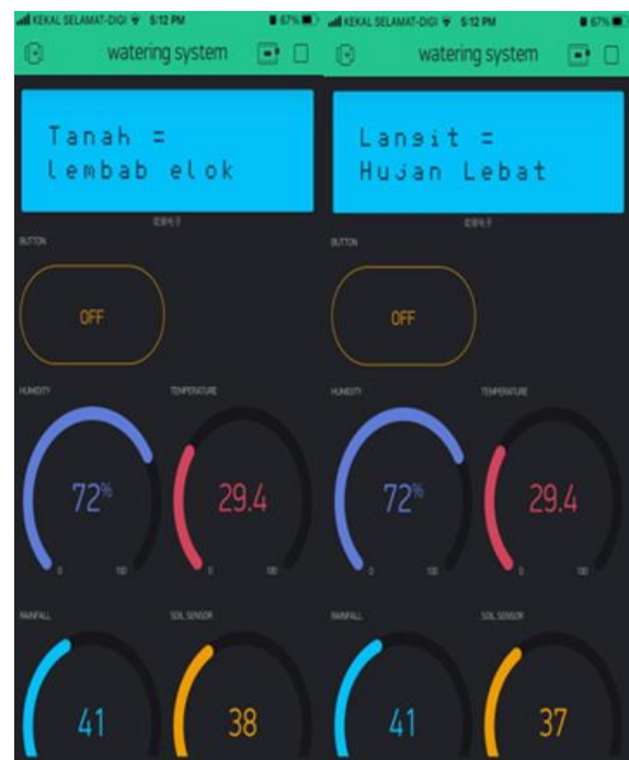
Rajah 3 (b): Bacaan di Blynk untuk sensor hujan dan sensor soil moisture apabila hujan
