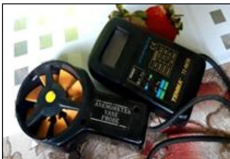
Rajah 4: Anemometer pengukur halaju angin
