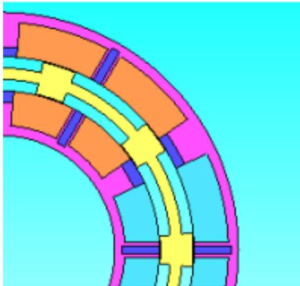
**Figure 2: Salient rotor PMFSM**
