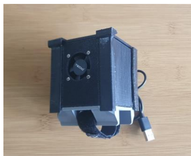
Fig. 10 Actual hardware of Hazardous gas sensing box
