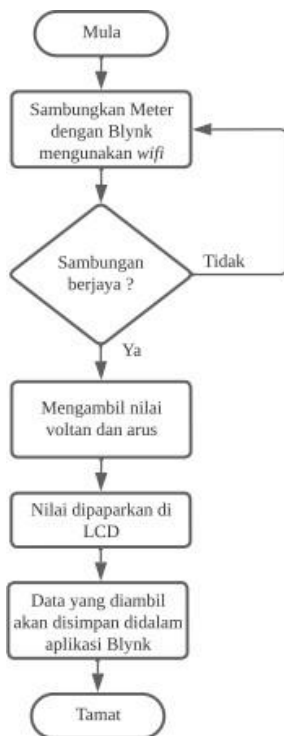
Rajah 1 : Proses Carta Alir Meter Mudah Alih IotT untuk Voltan dan Arus
