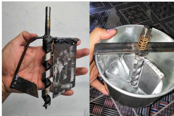
**Figure 7: Auger tool bit**
