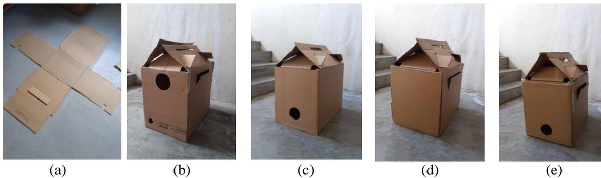
**Figure 12: PCTB functional prototype (a) die cut (b) A-Flute (b) B-Flute (c) E-Flute (d) AB-Flute**
