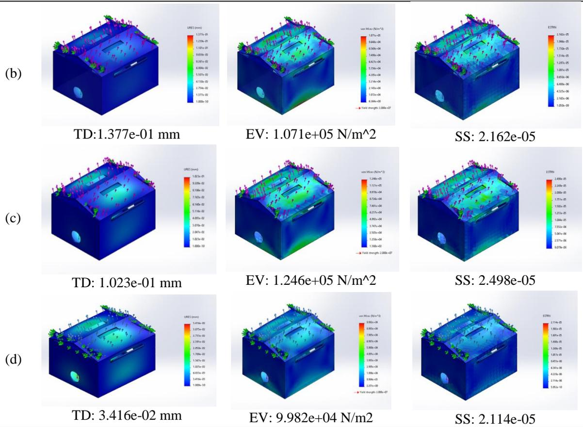
Figure 14: Solidworks FEA simulation diagram (a) A-Flute (b) B-Flute (c) E-Flute (d) AB-Flute
