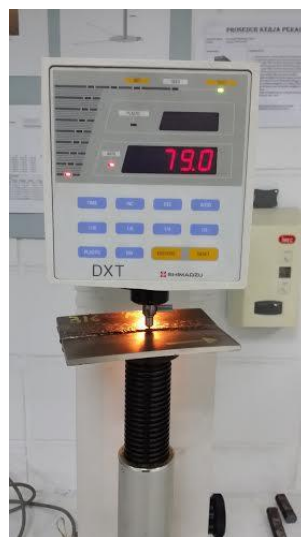
Rajah 2: Bahan kerja melalui ujian kekerasan Rockwell
