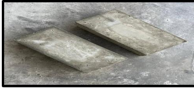
Rajah 6 Precast Slab Panel Campuran Abu Sekam Padi
