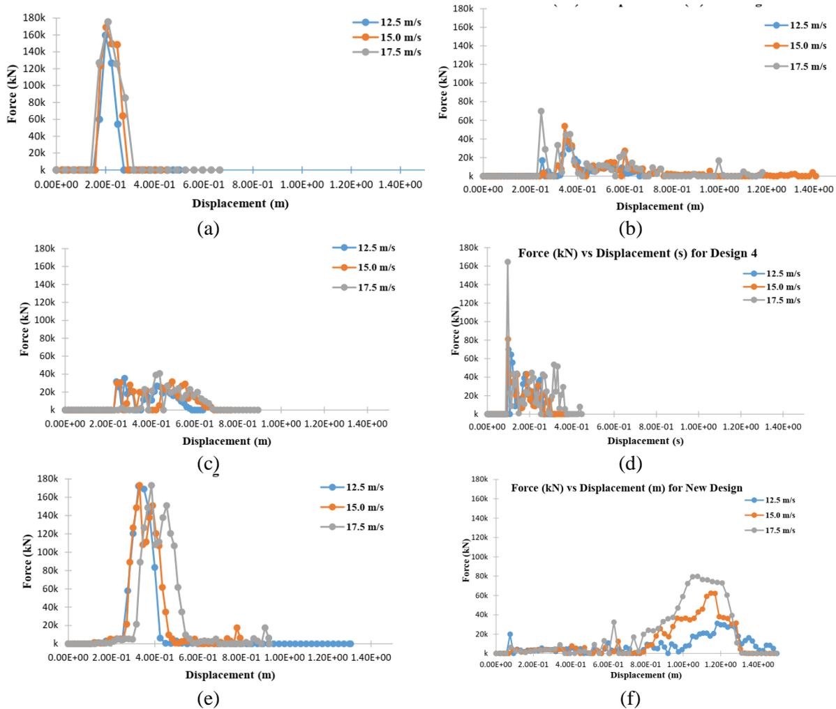
**Figure 4: Force versus displacement of (a) RUPD 1, (b) RUPD 2, (c) RUPD 3, (d) RUPD 4, and (e) Standard design**
