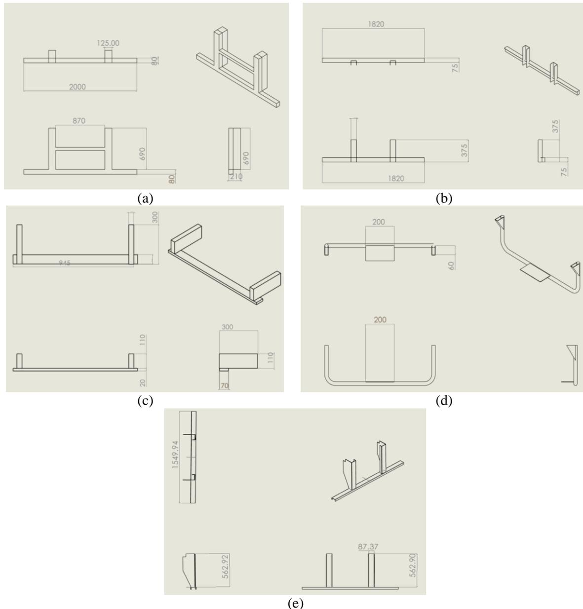
**Figure 2: Projection views, (a) RUPD 1, (b) RUPD 2, (c) RUPD 3, (d) RUPD 4 and (e) Standard design**
